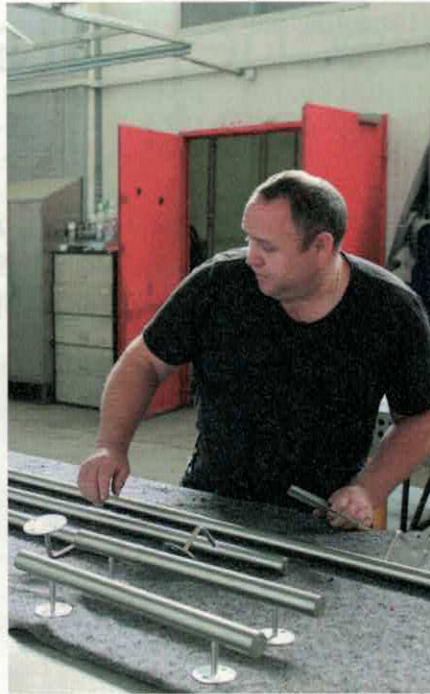
▲ Auftragsabhängig werden die Oberflächen der Edelstahl-Abschnitte noch geschliffen
